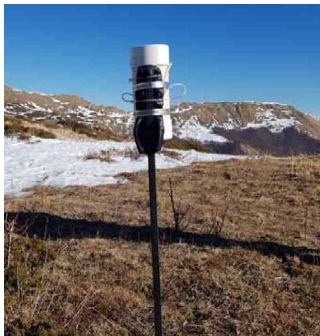
Figura 1 – Sensore pancromatico denominato Sky quality meter o buiometro installato presso il rifugio Battisti della Sezione CAI di Reggio Emilia - ph F. Meneguzzo
