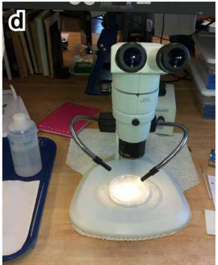
Fig. 3: fasi dell'estrazione e dello studio delle particelle di carbone macroscopiche conservate nei sedimenti. a) la carota di sedimenti viene campionata; b) i sedimenti vengono immersi per circa 24 ore in una soluzione ossidante e deflocculante; c) setacciatura dei sedimenti ormai disgregati; d) analisi del residuo allo stereomicroscopio.
