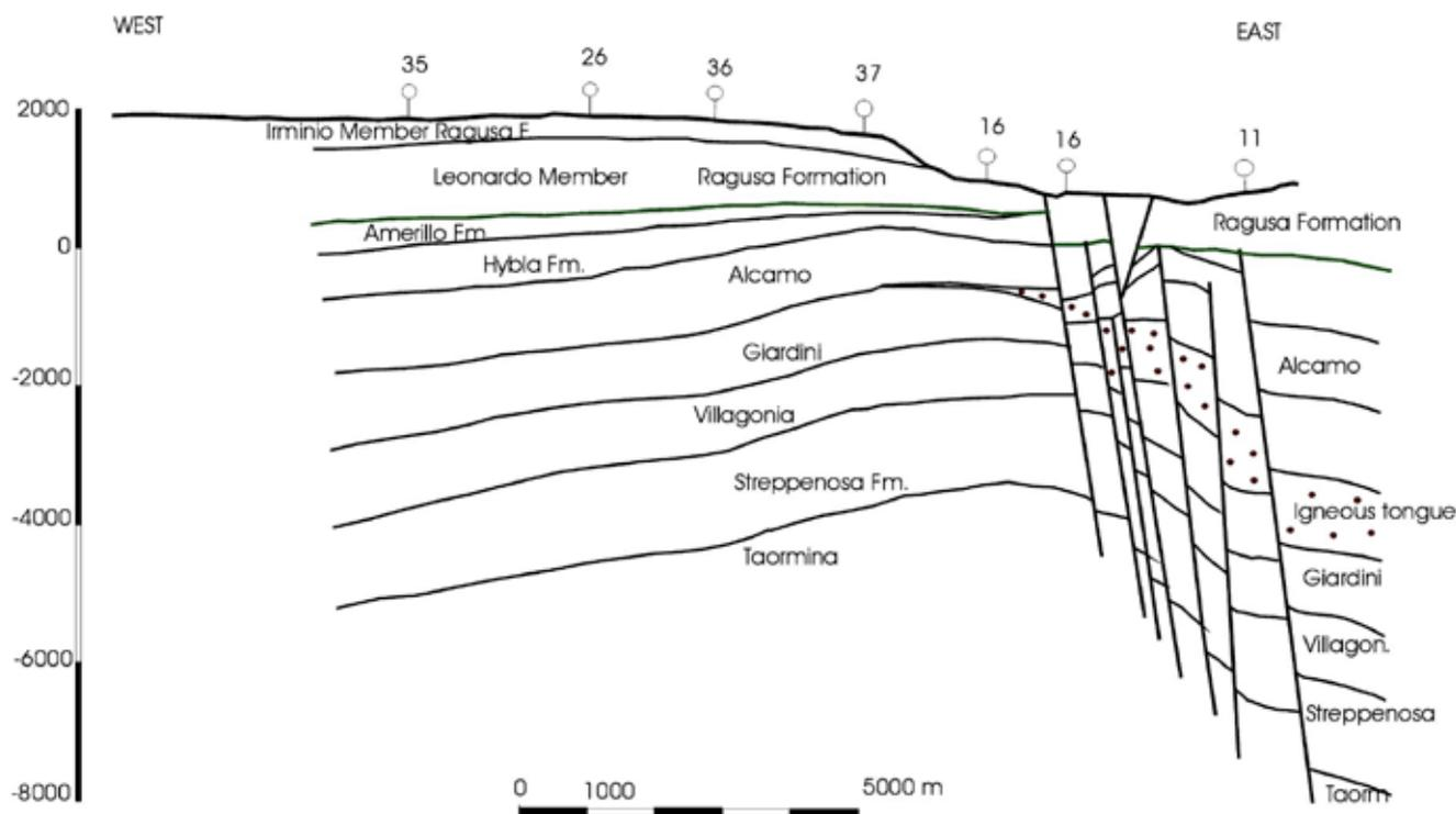
Fig. 7 a - Schema geologico stratigrafico-strutturale della zona asfaltifera iblea
