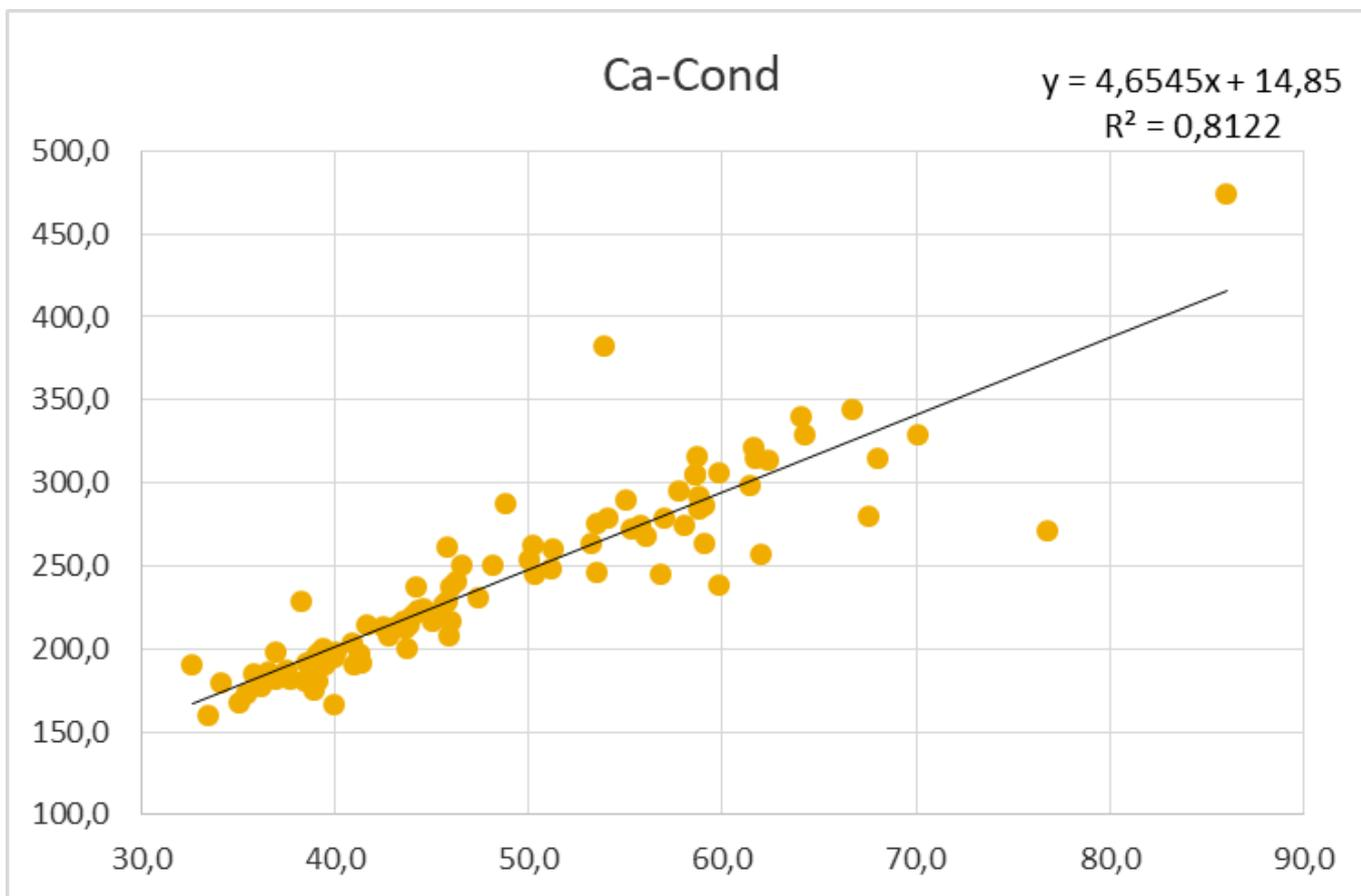
Fig.23 - Diagramma di correlazione della composizione chimica per tutte le sorgenti nell'intero triennio 2009-2011 fra Calcio (dato specifico relativo ad un elettrolita) e Conducibilità elettrica (dato aspecifico relativo a tutti gli elettroliti).
