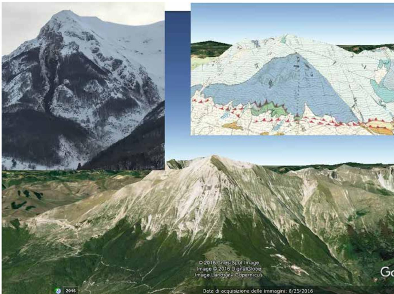
Fig.24 - . Lato Sud del Monte Vettore (m 2476): confronto con l'osservazione topografica in sezione degli affioramenti delle formazioni giurassiche; in evidenza in colore azzurrino il Calccare massiccio (acquifero principale dell'area) e il limite del sovrascorimento sulla Formazione della Laga a sud della catena, livello impermeabile che funge da aquiclude.
