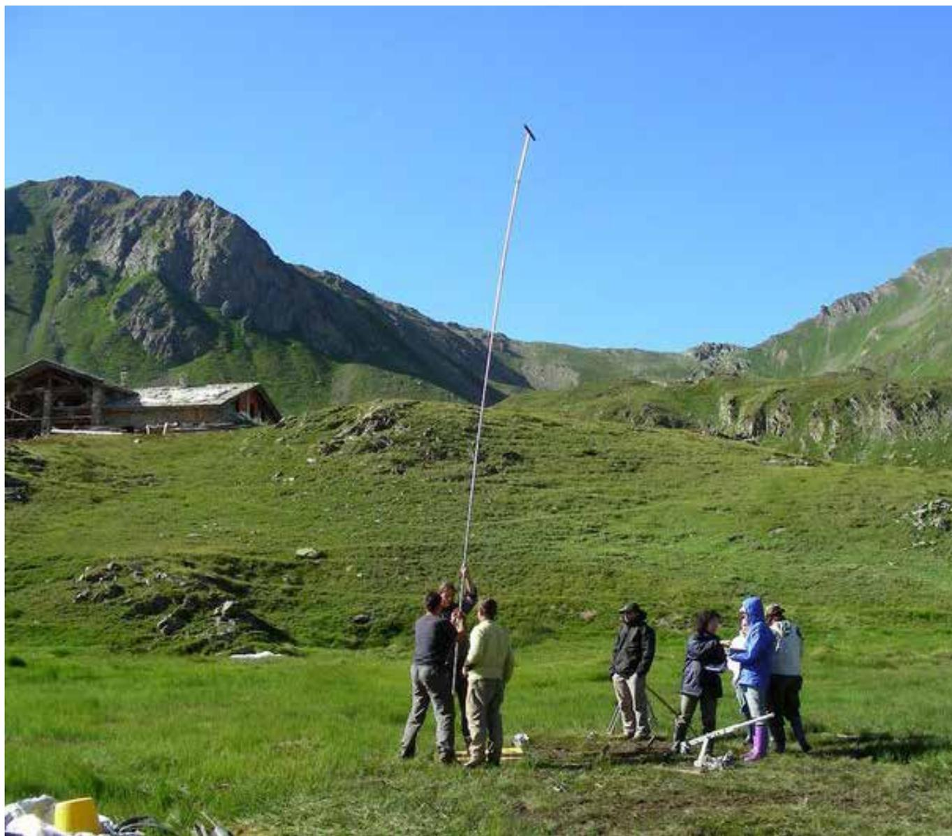
Fig. 2: il carotaggio stratigrafico che ha attraversato i depositi che riempiono la torbiera delle Crotte Basse (2365 m, Monte Fallère, Aosta). Il risultato delle operazioni è il recupero di un cilindro di limi, fanghi organici e torba lungo quasi 6 metri.
