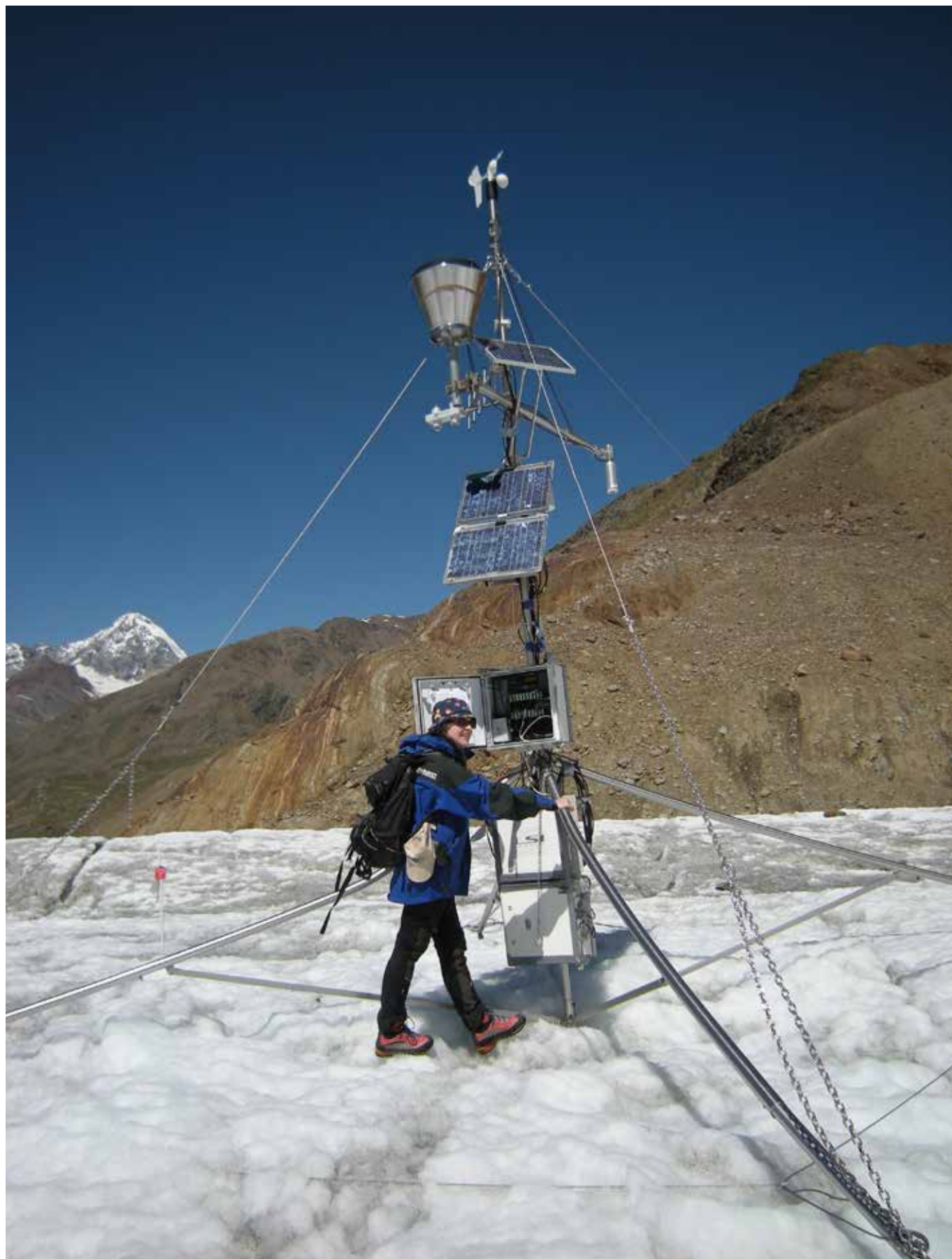
FORNI: La Stazione Meteorologica Automatica (AWS-Automatic Weather Station) collocata nel 2005 sulla lingua del Ghiacciaio dei Forni a 2700 m a cura dell'Università degli Studi di Milano, prima stazione italiana su ghiacciaio. Inserita in reti di misura internazionali, i suoi dati permettono studi approfonditi, ad esempio sull'evoluzione dell'albedo, anche in funzione della copertura detritica, e sul bilancio energetico del ghiacciaio con i suoi effetti sul bilancio di massa (ph. C. Smiraglia)
