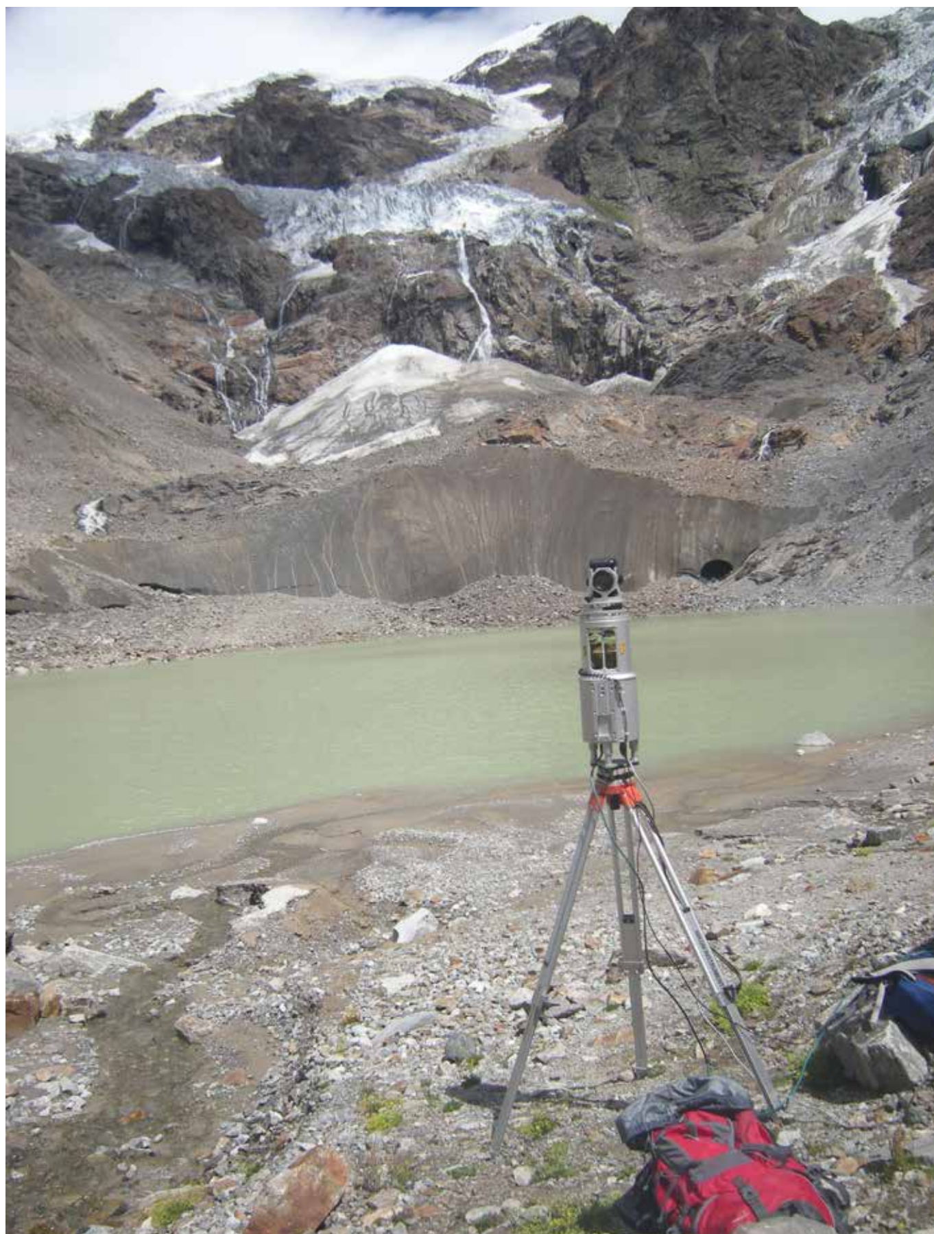
LYS: Rilievi laser scanner sul Ghiacciaio del Lys. Lo strumento permette di ottenere un modello tridimensionale ad alta definizione della lingua del ghiacciaio e del lago proglaciale. Ripetendo le misure e sovrapponendo i due modelli, è possibile quantificare le variazioni del ghiacciaio non solo areali ma anche volumetriche, variazioni che possono poi essere confrontate con i dati derivanti dalle analisi remote sensing (ph. C. Smiraglia)
