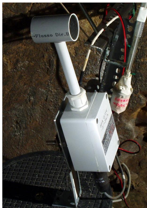
Sensore velocità dell'aria.
