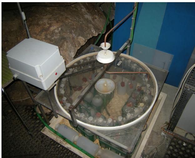
Fig. 5 - Campionatore automatico delle acque autocostruito dagli operatori del laboratorio.
