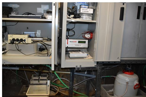
Fig. 8 - Misurazione in continuo del radon nelle acque: visione complessiva dei due sistemi di rilevamento AlphaGuard e Radon Mapper.
