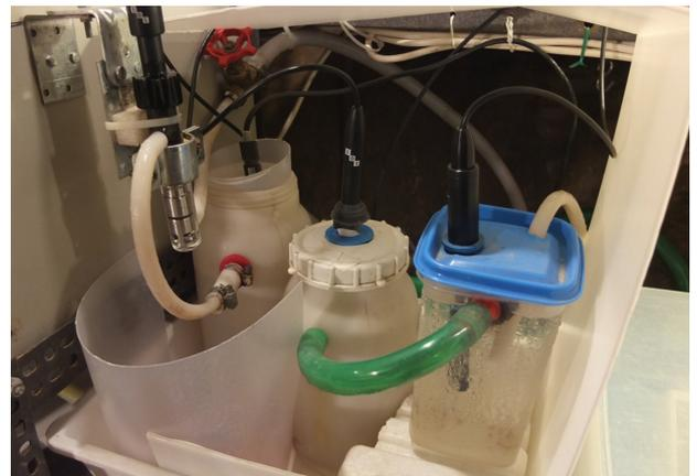
Foto 15 - I sensori per il monitoraggio di pH, Ossigeno disciolto, conducibilità elettrica.
