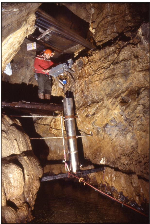
Fig. 3 - L'idrometrografo meccanico per la misurazione del livello del torrente sulla soglia dello stramazzo.
