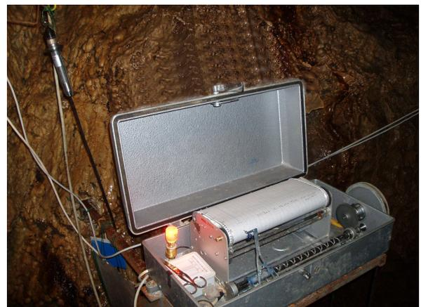
Fig. 2 - L'idrometrografo meccanico ad autonomia mensile.
