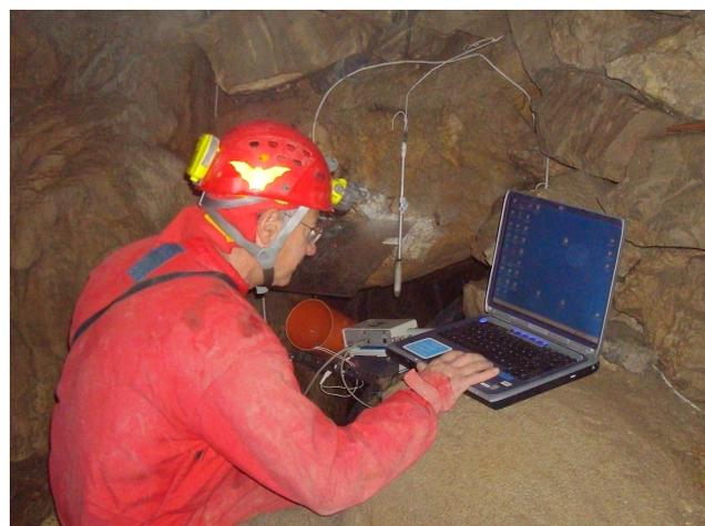
Fig. 15 - Misurazione del radon atmosferico nel Buco soffiante (Sala Garelli) tramite Sun Nuclear 1027.
