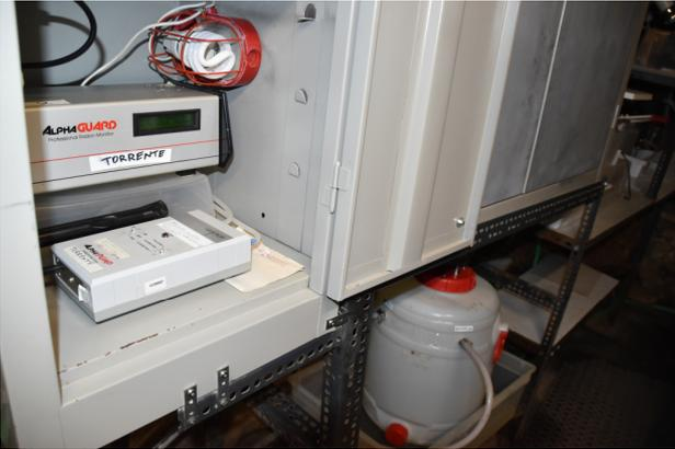
Fig. 19 - Sistema di rilevamento idrico continuativo tramite AlphaGuard (versione attuale): sotto il mdulo di scambio radon.
