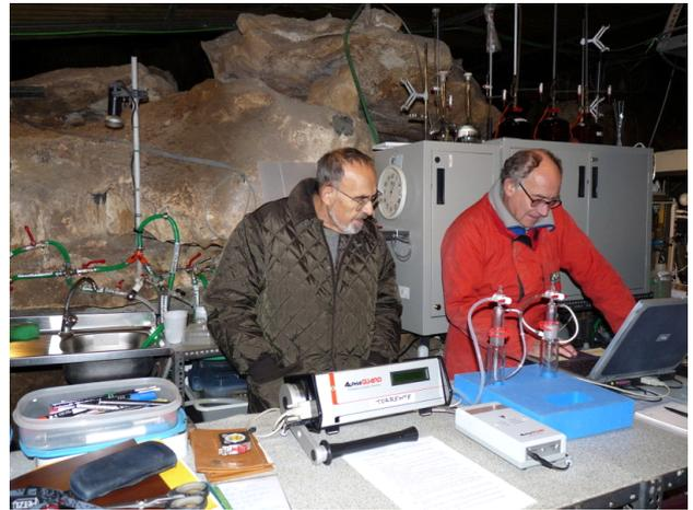
Fig. 21 - Rilevamenti idrici puntuali tramite AquaKit AlphaGuard.
