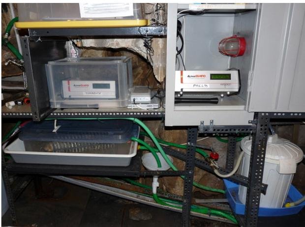
Fig. 17 - Sistemi di misurazione continuativa del radon disciolto nelle acque, tramite AlphaGuard (versioni iniziali).
