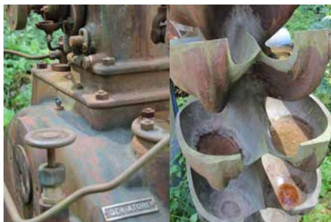
Foto 40, 41 e 42: Turbina della centrale idroelettrica (foto L. Cavinato)
