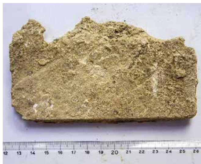
Fig.18 - Una lastra di lapis con segni di segazione (foto dal sito www.lapisspecularis.it )
