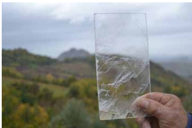
Fig. 13 -14 -15: Fasi di taglio di una lastra di lapis specularis (foto I. Fabbri)
