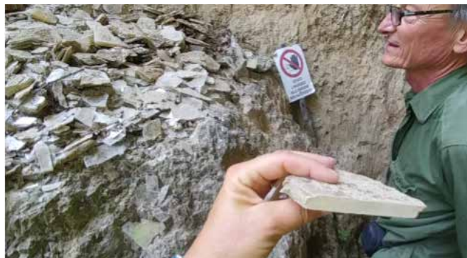
Fig. 57 - Particolare di scarti di lastre semilavorate con segni di segazione
