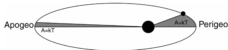
Figura 3.2. L'orbita di un satellite artificiale terrestre: il satellite spazza aree uguali in tempi uguali.
