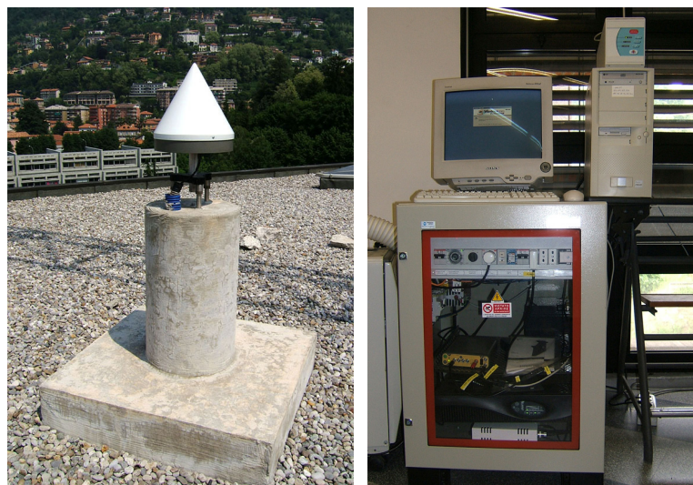
Figura 7.1. Una stazione permanente: l'esempio della stazione permanente di Como, inserita nella rete europea EPN e nel servizio di posizionamento di Regione Lombardia.
