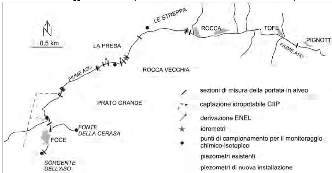
Fig. 2 - Schema di ubicazione delle opere di captazione e derivazione e dei punti di monitoraggio idrogeologico e chimico-isotopico lungo il corso del fiume Aso.
