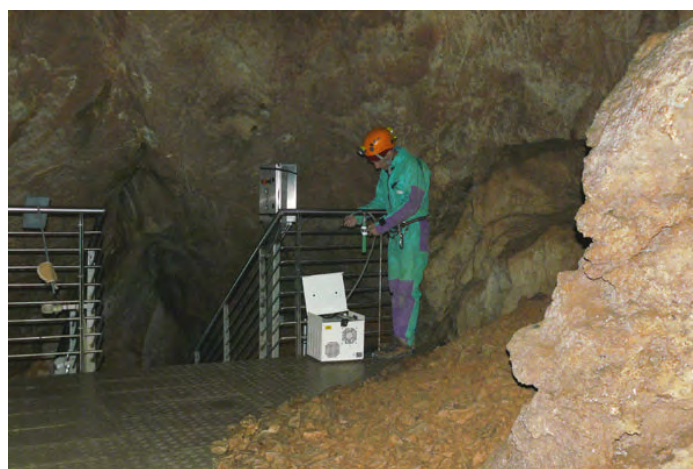
Fig. 3 – Allestimento del sistema di campionamento dell'aria mediante fiala di prelievo per gas e vapori e pompa volumetrica (4 agosto 2010) alla sommità della Galleria Franosa (Ramo turistico dell'Antro del Corchia).
