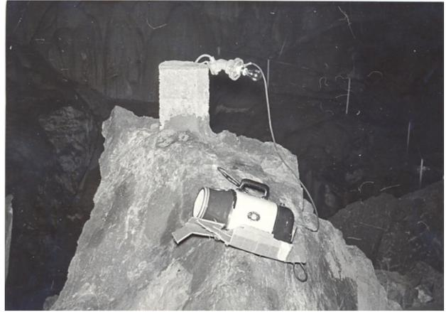
Fig. 4– L’aspiratore, alimentato dalla rete di illuminazione della grotta, in funzione poco a valle del Lago di Ernestina, sul Picco Rosarita.
