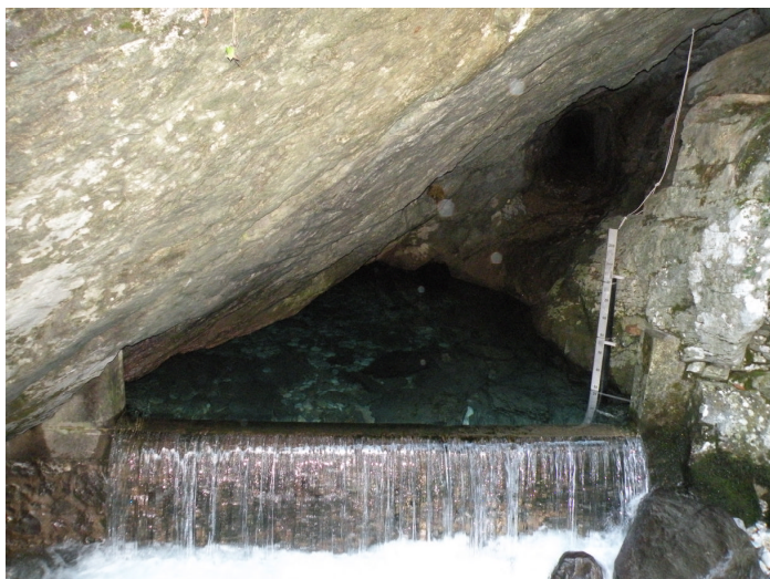
Fig. 2 – La sorgente Pollaccia, con l'asta idrometrica in cui trova alloggiamento la sonda multiparametrica. Lo stramazzo ha una larghezza di circa 5,4 metri.
